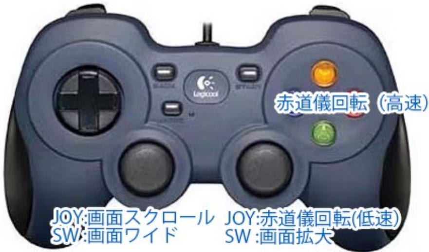
ジョイスティックは、横に倒すと、ジョイスティックとして機能します。垂直に押すと、スイッチとして機能します。
