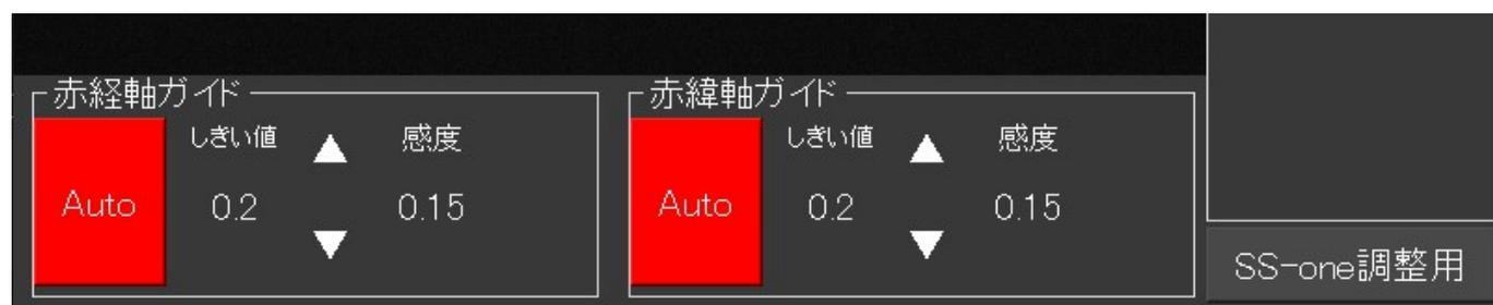
自動で暴れる場合は、暴れる方の軸(赤いグラフが赤経、緑のグラフが赤緯)の[Auto]ボタンを押して、[Fix](固定)にしてください。そのうえで、感度を0.10以下にします。
